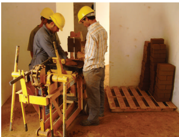
Fig. 3 Produção de BTC: prensagem [esquerda] e posterior cura [direita]
