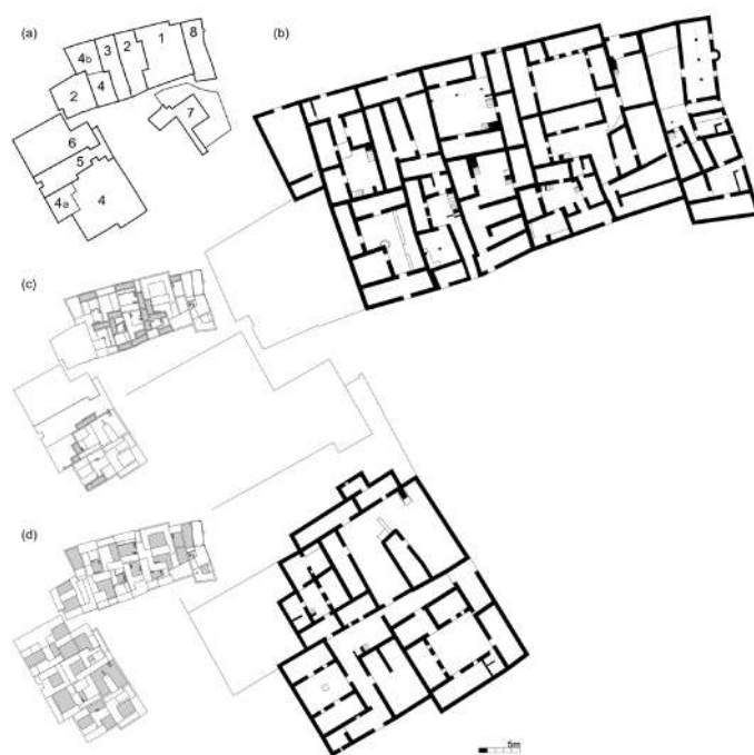
Fig. 4 Planta de conjunto de Tagnit n'Abdiy: a estrutura predial, 1-7 diferentes habitações 8 oratório (vestíbulo, pátio, cisterna, abluções, sala de oração, espaços domésticos) b piso térreo c compartimentos do piso superior d pátios, currais e espaços descobertos
