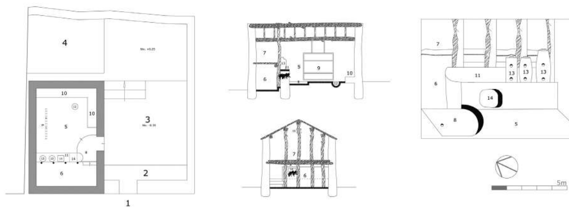
Fig. 1 Relevé d'une maison traditionnelle à son premier âge. Coupe longitudinale, coupe transversale, plan du RDC (ensemble) et perspective intérieure 1 entrée 2 asqif 3 cour 4 jardin 5 thaqaâts 6 adaynin 7 thaârichth 8 amnar 9 azetta 10 adhukan 11 thadukant 12 elkanun 13 akoufi 14 mangeoire (Zoulikha Ait-Lhadj, enquête terrain 2017/2018)
