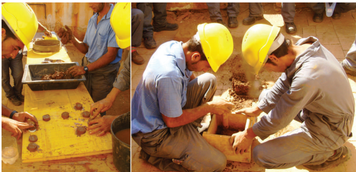
Fig. 4 Testes de terreno: pastilhas – dilatação/retração [esquerda]; teste Carazas e provetes [direita]
