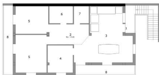
Fig. 6 Plans d'une extension à côté d'une ancienne maison à Ifigha-centre. Plans de l'étage et du RDC 1 entrée 2 hall 3 séjour 4 cuisine 5 chambre 6 sanitaires 7 cellier 8 balcon (Zoulikha Ait-Lhadj, enquête terrain 2017/2018)
