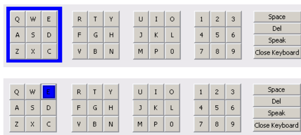
Figura 4.4: Exemplo do sistema de varrimentos implementado no EasyVoice .
