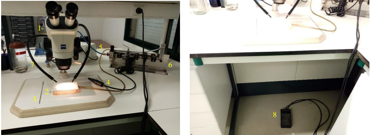
Figura 16 - Equipamento utilizado para a seleção, tratamento e anestesia de D. melanogaster . Legenda: 1-Lupa; 2-Flypad; 3-Palheta de seleção?; 4- Injetor de CO2 (para garrafas); 5-Controlador de intensidade da luz; 6- Controlador da administração de CO2; 7- Mortuário dos espécimes; 8- Pedal de administração de CO2 para o flypad
