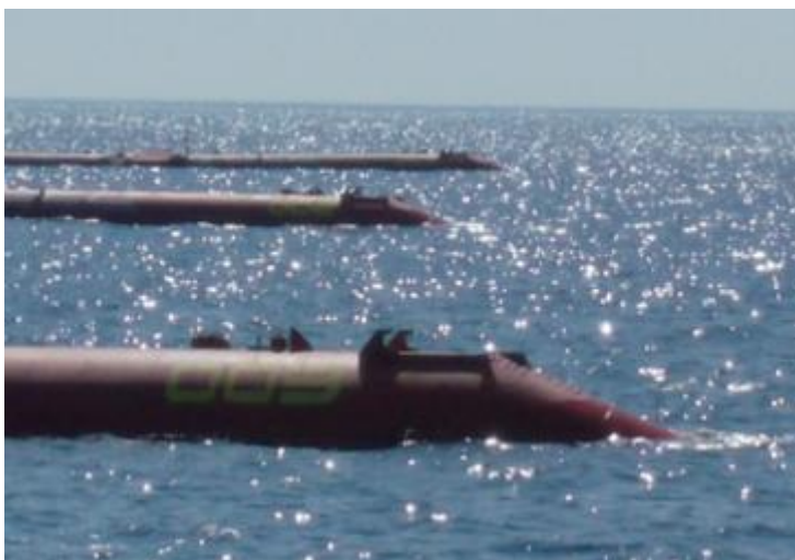
Figura 2.16. Sistema atenuador, Pelamis, em Aguçadora. Adaptado de (Brito e Melo, 2010).
