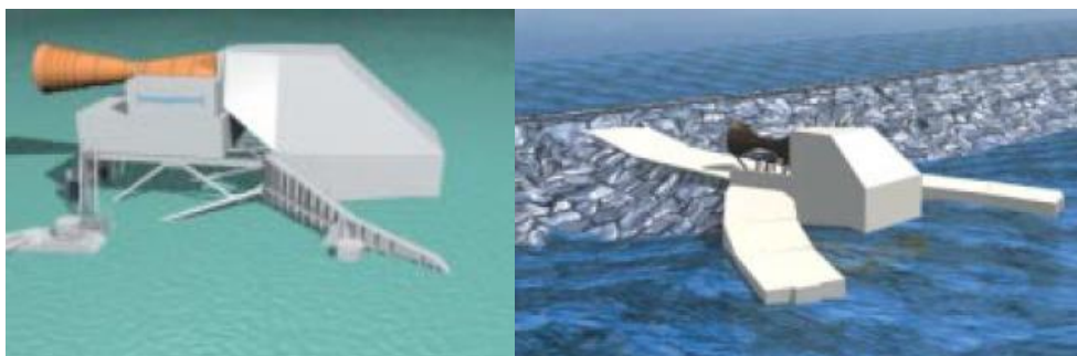
Figura 2.5. Sistema de Coluna de Água Oscilante da Energetech. Adaptado de (Cruz e Sarmiento, 2004).
