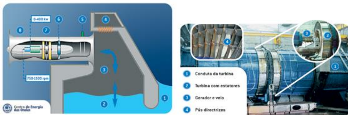
Figura 2.13. Esquema da central piloto em Porto Cachorro: exterior (esquerda) e interior (direita). Esquerda: 1 – Onda incidente; 2 – Coluna de água; 3 – Câmara pneumática; 4 – Válvula de alívio; 5 – Válvula de isolamento; 6 – Válvula de manobra; 7 – Turbina wells; 8 – Gerador assíncrono; Direita: 1 – Conduta da turbina; 2 – Turbina com estatores; 3 – Gerador elétrico; 4 – Pás diretrizes. Adaptado de (Neumann, 2011).
