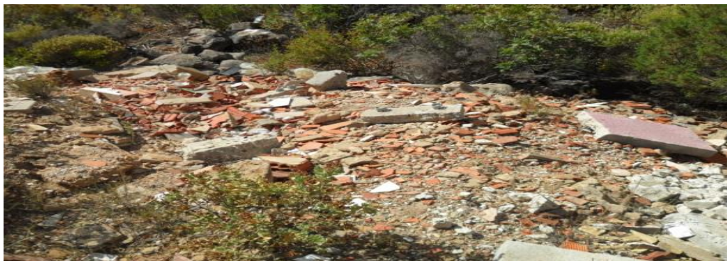
Figura 5.16-Resíduos de alvenaria, aglomerados de argamassas e revestimento de pavimento (Depósito perto da Fábrica do Cimpor).
