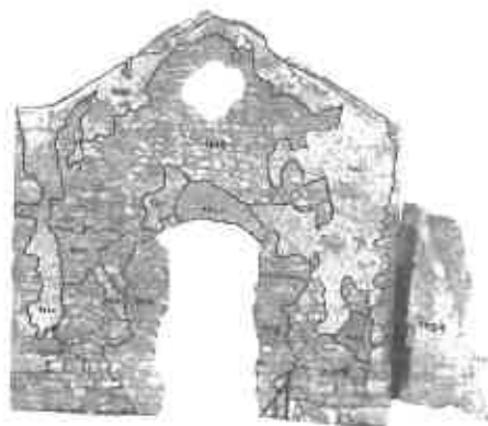
Figura 23 - Interface de destruição (ruína) do portal de entrada posteriormente refeito pela DGEMN (M. Ramalho, 2007)
