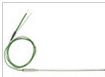
Figura 32 - Termopar para a medição dos gases de combustão.
