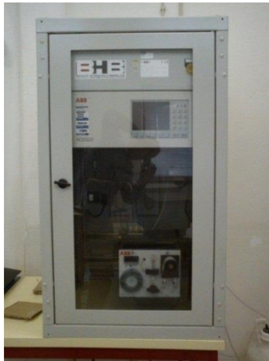
Figura 16 - Móvel com a unidade analisadora e com a unidade acondicionadora dos gases de combustão.
