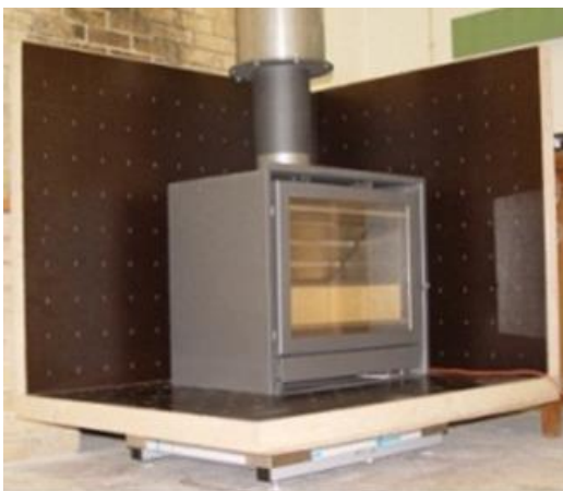
Figura 24 - A bancada de ensaio - o triedro.
