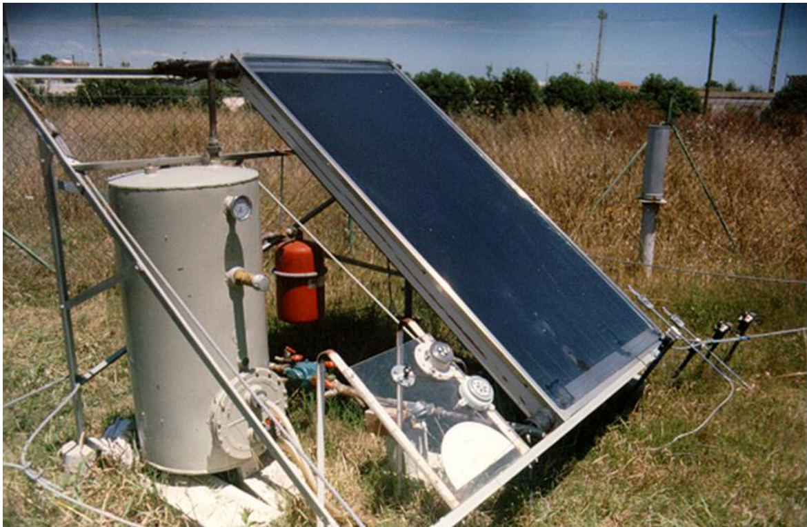
Figura 51 - Foto da instalação experimental para a determinação da recta do rendimento de um colector solar.
