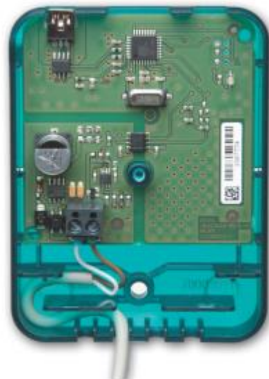
Figura 41 – Controlador BX da Resol (Vbus/USB interface)
