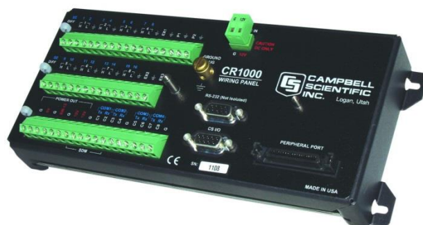
Figura 43 – Sistema de aquisição de dados do pavimento radiante.
