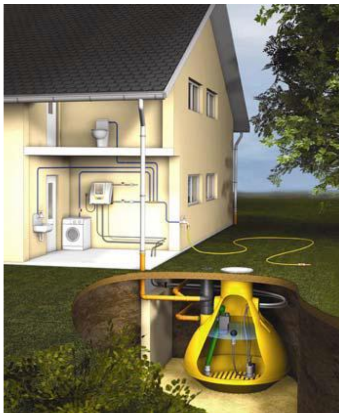
Figura 118 - Sistema de aproveitamento de águas pluviais [141]
