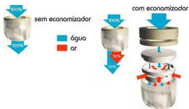
Figura 85 - Esquema de funcionamento de um redutor de caudal [158]
