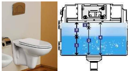
Figura 78 - Autoclismo com dupla descarga [34].
