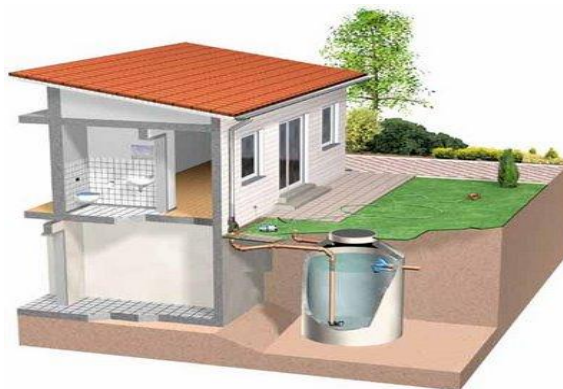
Figura 70 - Armazenamento das águas das chuvas [31]
