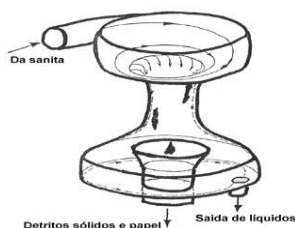
Figura 80 - Esquema de sistema de aproveitamento de composto [34]
