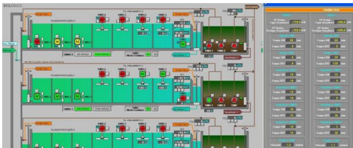
Figura 2.8 - Sinóptico do tratamento biológico da ETAR de Albufeira Poente (Fonte: AdA, 2021)
