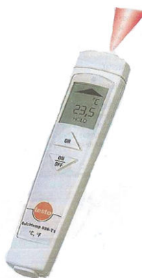
Fig. 2.18: Termómetro com mira a laser – Testo Quicktemp 826-T2 .
