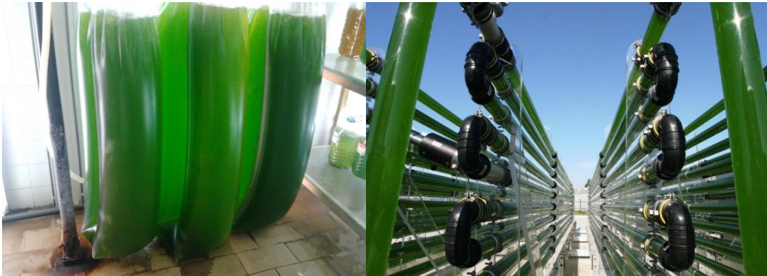
Figura 1.4 Modelos de fotobiorreactores: A) Mangas plásticas (polietileno), cultivo da CTP4 nas instalações do LEOA (fotografia original) B) Fotobiorreator tubular (retirado de www.wageningenur.nl ; 2009).
