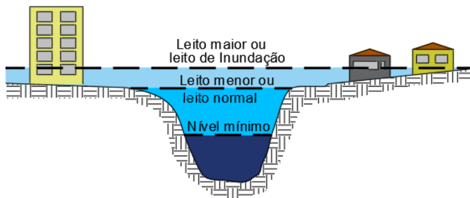
Figura 2.16 – Representação do leito normal e de inundação num canal, numa área urbanizada. Nesta situação, quando a água ultrapassa o leito normal atinge as atividades humanas que estão ocupando as margens.
