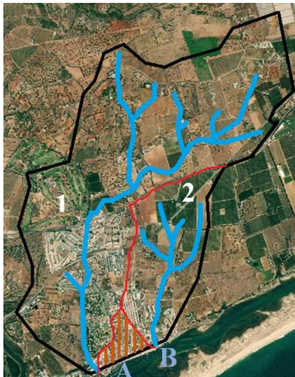
Figura 3.3 – Ribeira da Canada (1) e Ribeira do Pocinho (2) e suas linhas d'águas (linha azul). As fozes de ambas estão nomeadas como A, B. A região representada por linhas inclinadas laranja tem seu deságue direto na Ria formosa, através de dispositivos de drenagem. A linha vermelha representa a divisão entre as sub-bacias.
