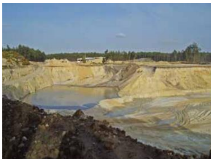
Figura 2.18 - Afloramento da toalha freática provocando lagoas artificiais (Epal, 2018).
