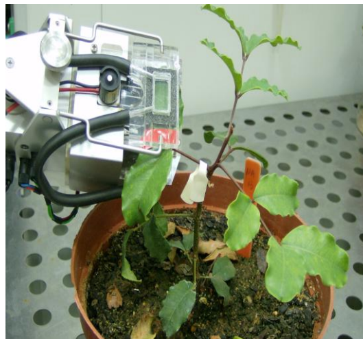
Figura 2.2. Medição das trocas gasosas em C. siliqua .
