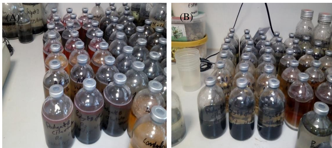
Figura 3.3 (A) -Início do ensaio de águas ruças no tratamento de DAM e vertido de zincado ; (B) – Final do ensaio de águas ruças no tratamento de DAM e vertido de zincado .
