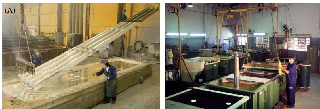
Figura 2.4- Processos de galvanização: (A) – Hot-dip galvanization. Fonte: http://eng.galvano.no/?ac_id=12 (B) – Deposição eletrolítica. Fonte: http://mundoeletrolitico.blogspot.pt/
