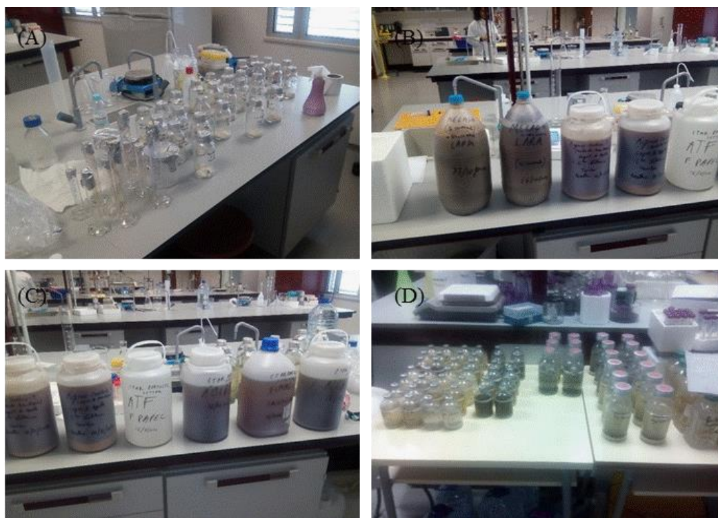
Figura 3.1 - (A) - Frascos de 250 ml com calcite; (B) e (C) - Alguns dos subprodutos testados; (D) - Ensaio de seleção das fontes de carbono alternativas para o crescimento de BSR.
