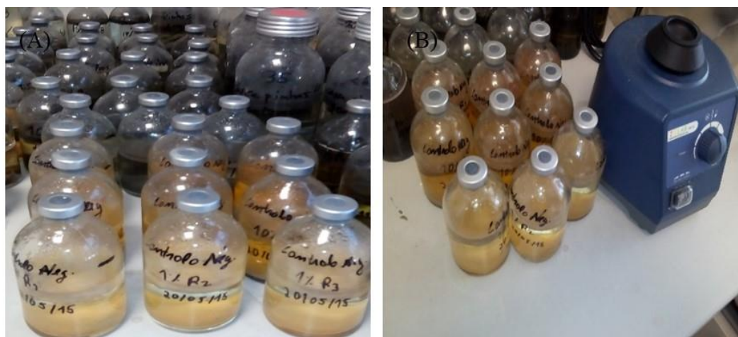
Figura 3.2- (A) - Ensaio de Carbocal® com DAM São Domingos; (B) - Ensaio de Carbocal® com vertido de zinco .
