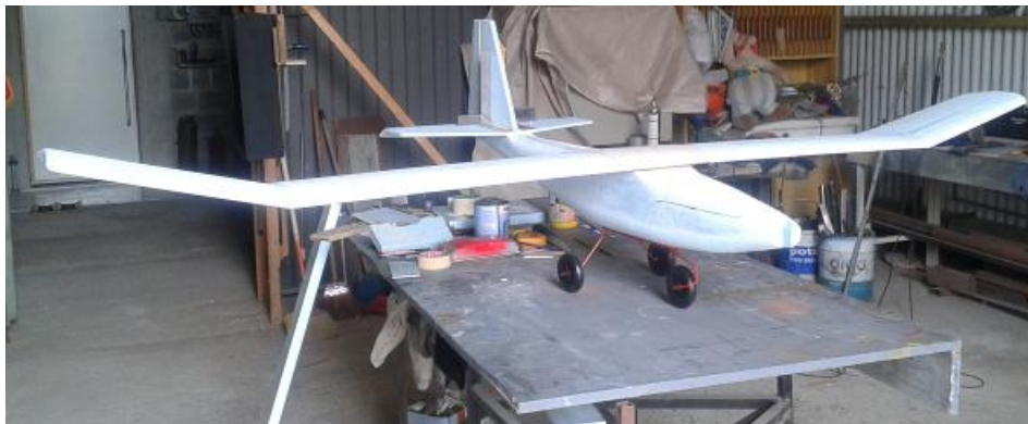
Figura 3.8: Colagem dos lemes, e fixação do trem de aterragem.
