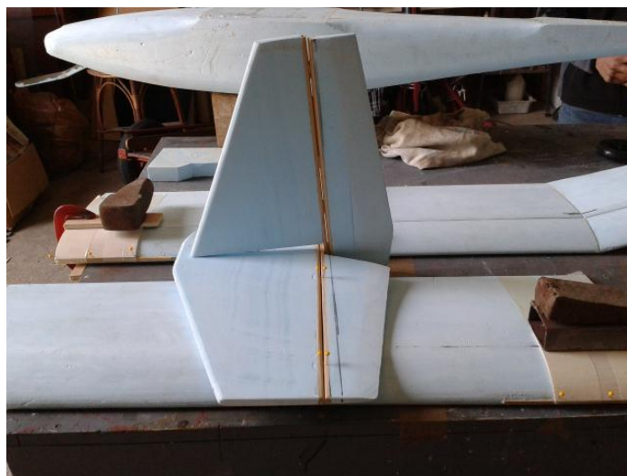
Figura 3.3: Construção dos lemes e reforço das uniões dos lemes e das asas.
