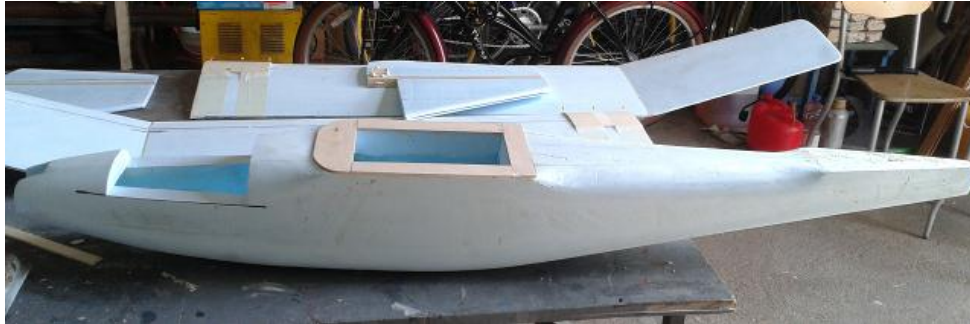
Figura 3.4: Melhoramento da fuselagem, cortes e reforço da fuselagem e do leme de direção.
