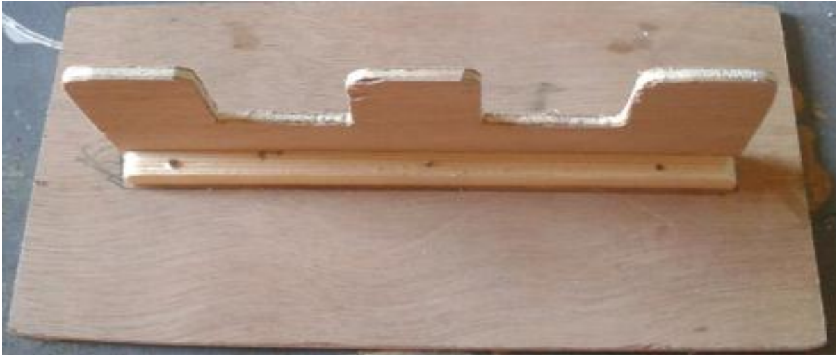
Figura 3.12: Suporte para o recetor rádio, controlador de servos, circuito do multiplexer , e HUB USB.
