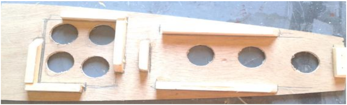
Figura 3.11: Suporte para a bateria Li-Po e para a bateria de 4.8 V que alimenta o HUB USB.
