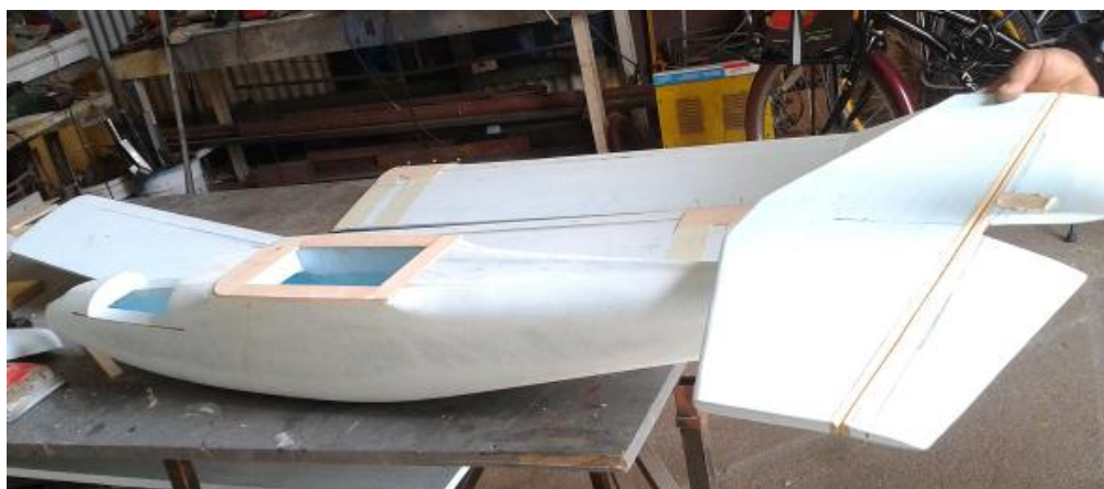
Figura 3.5: Reforço em contraplacado no leme de profundidade.
