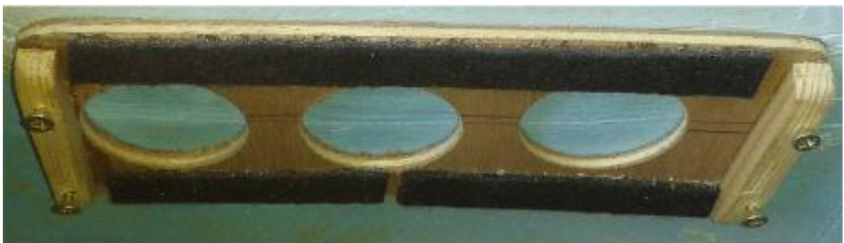
Figura 3.14: Suporte para fixação do SBC Snowball.
