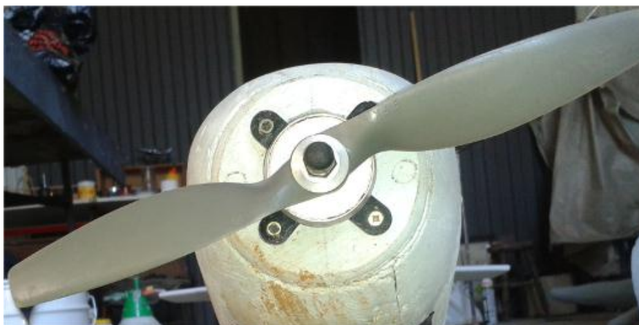
Figura 3.9: Fixação do suporte do motor, do motor e da hélice.
