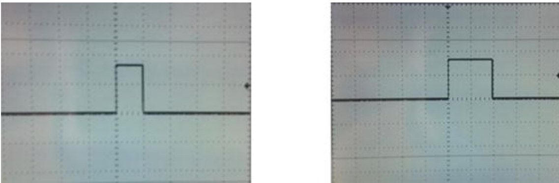
Figura 4.1: Pulso mínimo (esquerda), Pulso máximo (direita) (Escala: X- 1 ms, Y- 2 volt).
