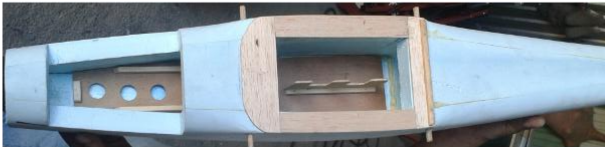
Figura 3.13: Instalação dos suportes no interior do AMT.
