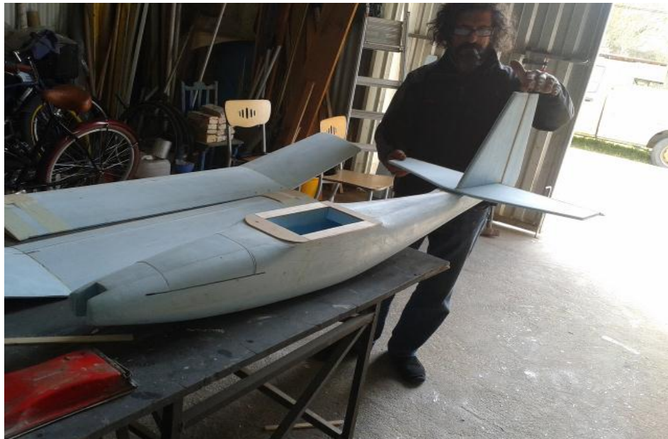
Figura 3.7: Preparação da colagem dos lemes.
