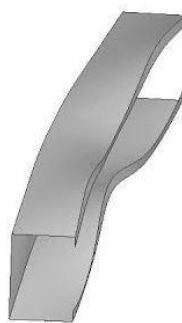
Fig. 8- Modo de distorção de uma coluna. [14]
