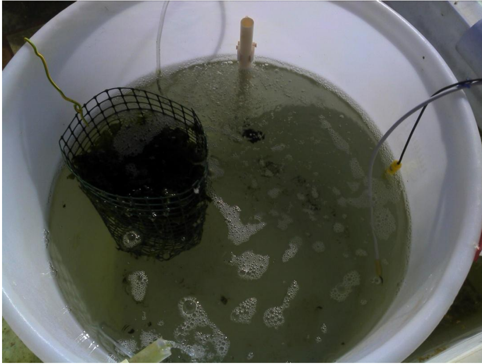
Figura 3.3 - Tanque interior (visível a amostra de algas, sensor de pH, de temperatura, torneira de entrada de água, tubo injetor de ar, tubo de nível)
