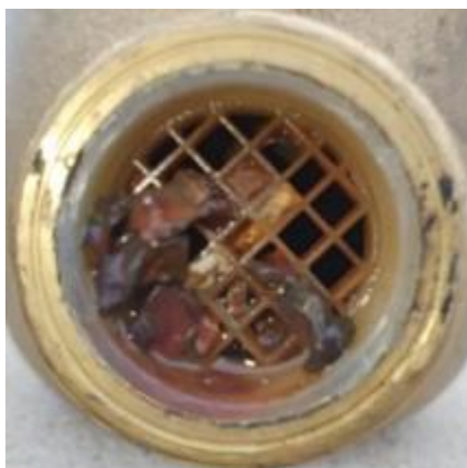
Figura 6. Entupimento causado por partículas de dimensão considerável em suspensão
