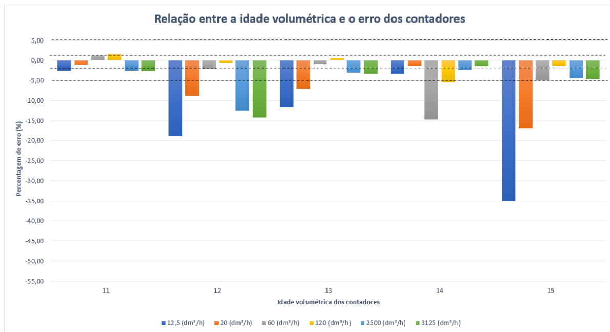
Figura 67. Análise aos erros de medição no intervalo de medição dos 11 aos 15 anos
