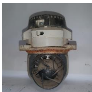
Figura 23. Turbina de pás helicoidais (Woltmann)
