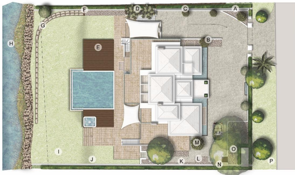
Figura 1.11. Plano Geral do Lote Palmeiras 11 em 2009, Quinta do Lago. Legenda: A - Canal de drenagem; B - Cipreste em canteiro para dar destaque vertical; C - Sebe de Eugenia para dar privacidade; D - Palmeiras; E - Área de deck ao lado da piscina; F - Muro de contenção feito por travessas verticais de madeira; G - Retenção de rochas; H - Lago; I - Área de relvado ao nível inferior para dar a ideia de ligação visual com a paisagem envolvente; J - Relvado; K - Calçada que dá acesso pela área de plantação entre a parte de trás e a parte da frente do jardim; L - Revestimento de seixo branco; M - Limoeiro; N - Muro de contenção de cimento; O - Todos os Pinheiros existentes a serem operados; P - Relvado ao lado da fachada da propriedade.
